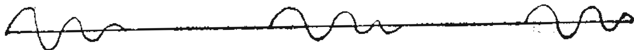
Successioni di treni di oscillazioni ammortizzate nel circuito
